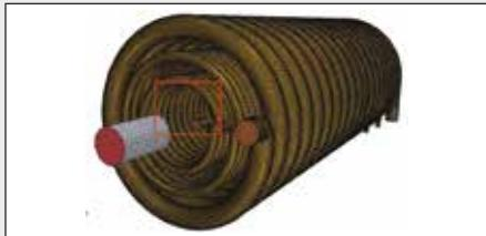
Simulation numérique d'un modèle de refroidissement d'un réacteur chimique
